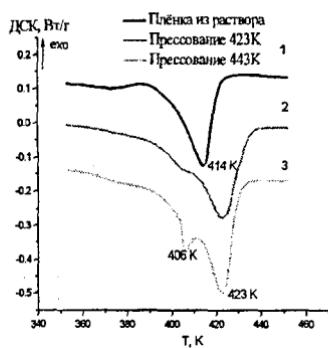
ис. 2. ДСК кривые различных образцов полимера.
