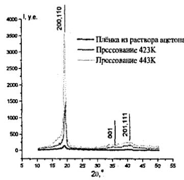
Рис. 3. Сравнение рентгенограмм для разных образцов полимера.
