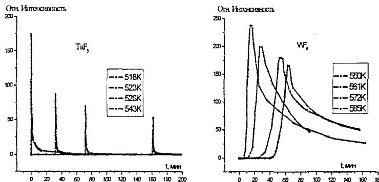
Рис. 6. Зависимость скорости образования  $TaF_5$  и  $WF_6$  от времени в системах Та-Ф42, В-Ф42, соответственно, при разных изотермических условиях.
