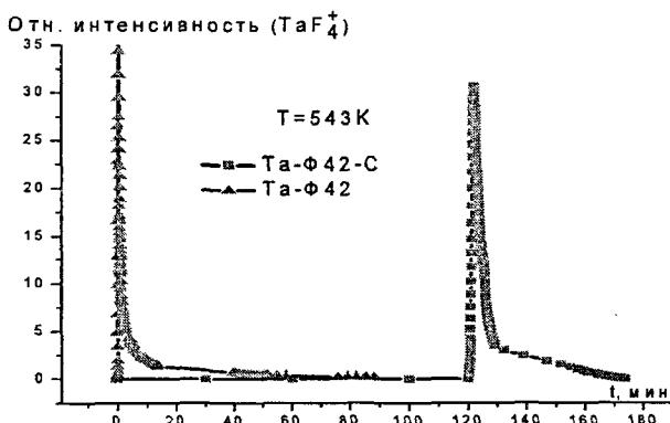
Рис. 11. Зависимость скорости образования  $TaF_5$  в системе Та-Ф42 и Та-Ф42-С
