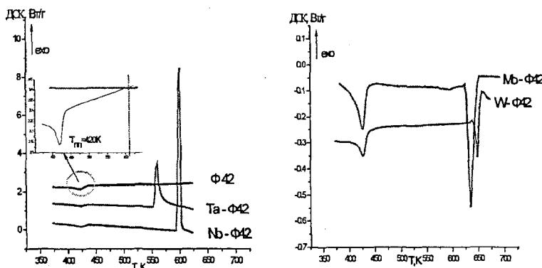
Рис. 4. ДСК кривые для систем М-Ф42 и сополимера Ф42, снятые в атмосфре Ar при скорости нагрева 10 °/мин.
