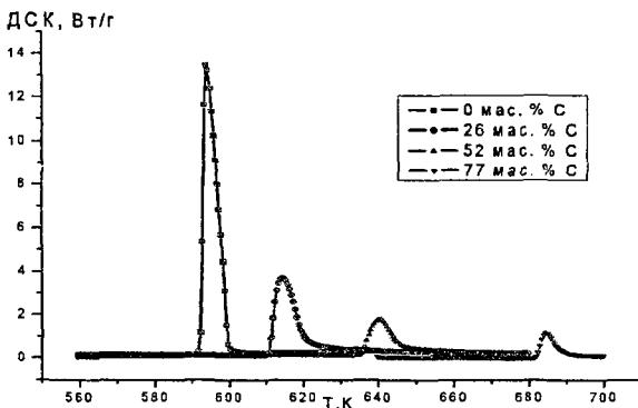
Рис. 10. Кривые ДСК при 10К/мин для разных составов.
